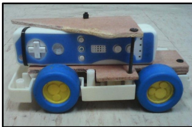
Figura 5. Móvil con WiiMote como sensor remoto de G.
