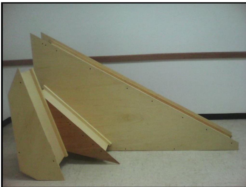
Figura 1. Plano Inclinado Galileano Múltiple de 15°-75°, 45° y 30°-60°.
