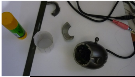
Figura 10. En esta imagen están los cortes de tubo que se hicieron a medida para que pudieran embonar con la cámara web y el telescopio
